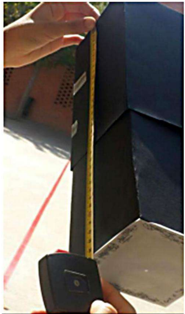
Fig. 9: Medida de la longitud de la cámara ( L_2 )
